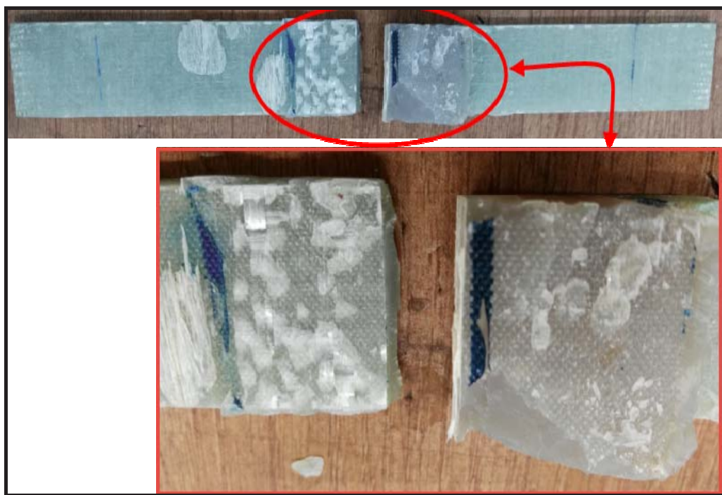
شکل (۶): الگوی شکست در اتصال به وسیله‌ی اروزیل با ضخامت ۱۳ میلی‌متر.
