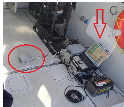
شکل ۴: نصب GPS بر روی سقف کابین و نصب ثبت رفتار در موقعیت LCG
