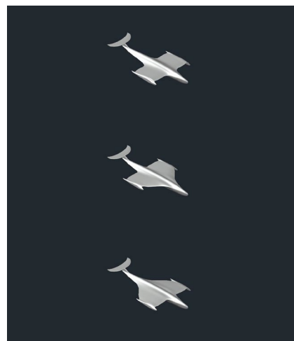
شکل ۶- نمای ایزومتریک طراحی مفهومی مدل‌ها از بالا به پایین به ترتیب بال مستقیم (STR)، بال پسرو (SWB)، بال پیشرو (SWF).
