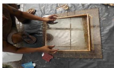
شکل ۱۲- فرایند دستی ساخت کامپوزیت هیبریدی شیشه-نارگیل (HCGFRP)
