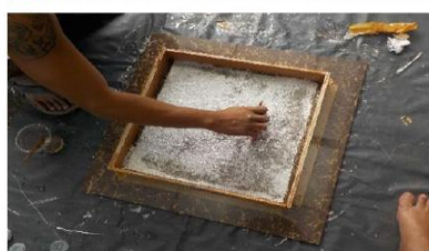
شکل ۱۲- فرایند دستی ساخت کامپوزیت هیبریدی شیشه-نارگیل (HCGFRP)
