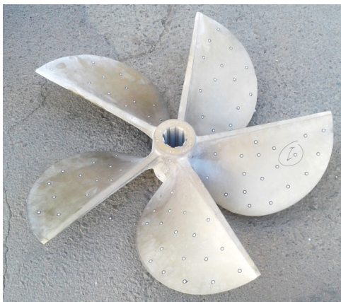
شکل ۲- نمای پروانه نیمه مغروق 5*980*770
