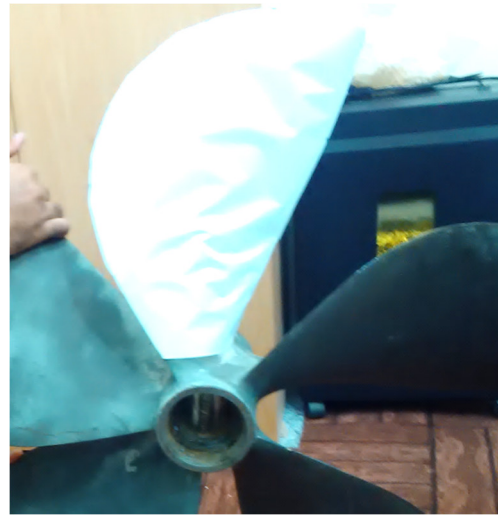
شکل ۳- نمای تهیه شابلن از پره ها
