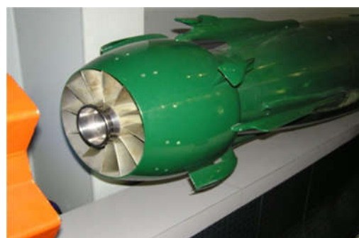
شکل ۱: سیستم رانش پمپجت و اجزای مربوطه
