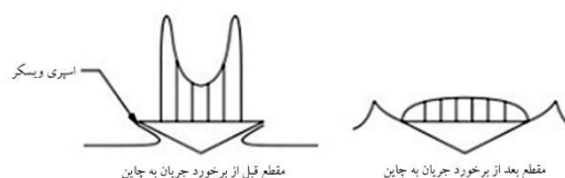
شکل ۳- شماتیک پروفیل فشار قبل و بعد از رسیدن
