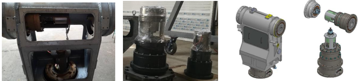
شکل ۶. تصاویر موتور گشتاوری و پدستال الف) طراحی نقشه موتورهای با سالیدورک. ب) طراحی پدستال با سالیدورک. ج) موتورهای انتخاب شده. د) نصب موتورهای بر روی پدستال
