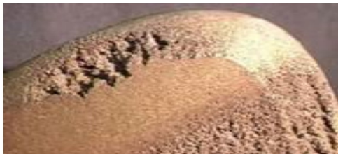
شکل ۱۱- اثر خوردگی پره به سبب کاویتاسیون [۲۵]
