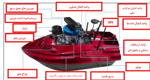
شکل ۲- شماتیکی از اجزای اصلی در شناور سطحی بدون سرنشین نمونه [3]
