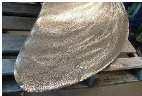
شکل ۱- نمونه‌ای از خوردگی کاویتاسیون بر روی پروانه دریایی [۱]
