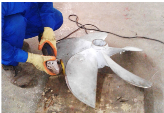
شکل ۷- نحوه برش کاری پروانه
